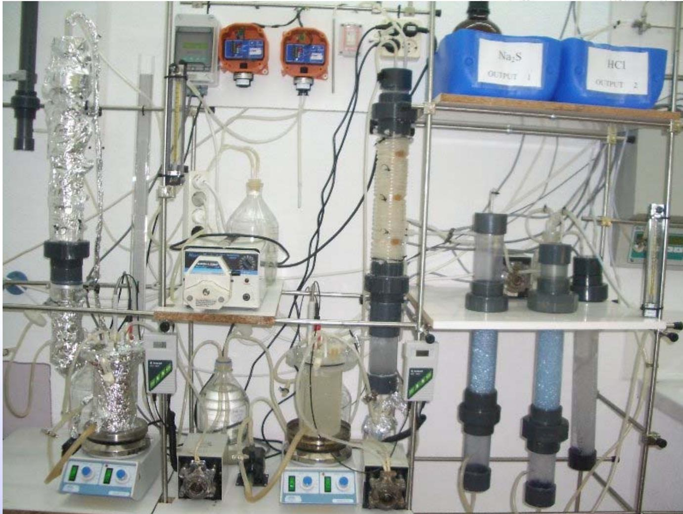
Montaje biofiltros de escurrimiento. Escala de laboratorio. Eliminación  $\text{H}_2\text{S}$  y  $\text{NH}_3$
