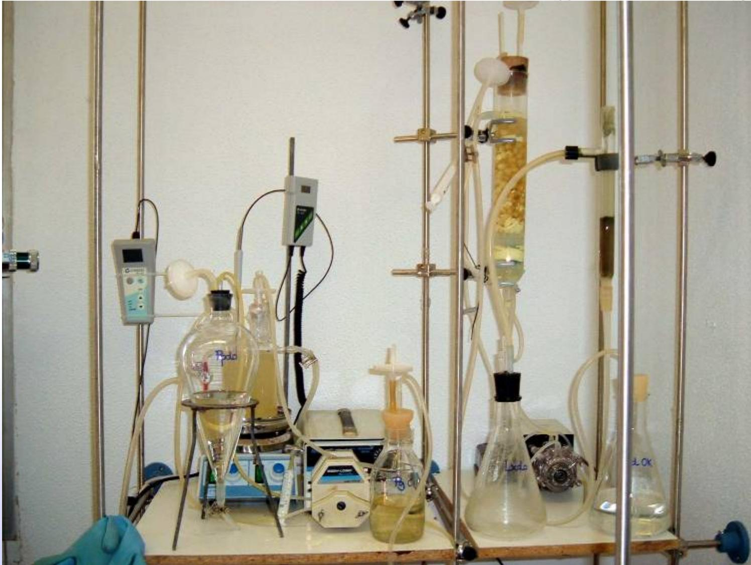
Proceso integrado de biolixiviación y bioprecipitación
