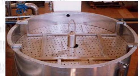
Tapa de sujeción del cuerpo del reactor
