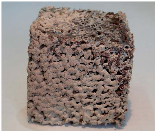
Limpieza del azufre retenido en el soporte cambiando el modo de flujo
